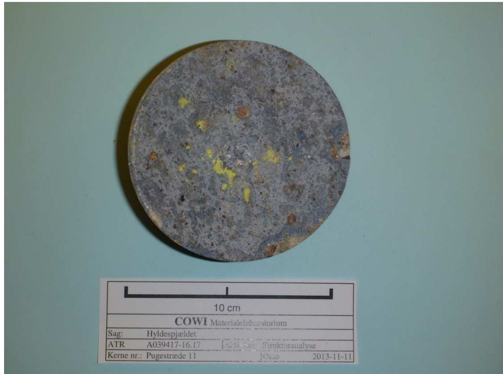
Kerne K2: Ydre overflade fremstår blå-grå og med frilagt stentilslag – frilagt ca. 5 mm.
