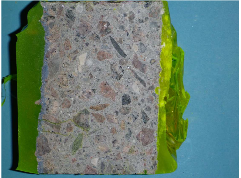
Kerne K3: Overflade er placeret tv. i foto. Kernen efter imprægnering med fluorescerende epoxy og gennemskæring på langs. Der ses 2 grove revner vinkelret på overfladen med forløb indtil ca. 30 mm. Revner skærer tilslagskorn.
