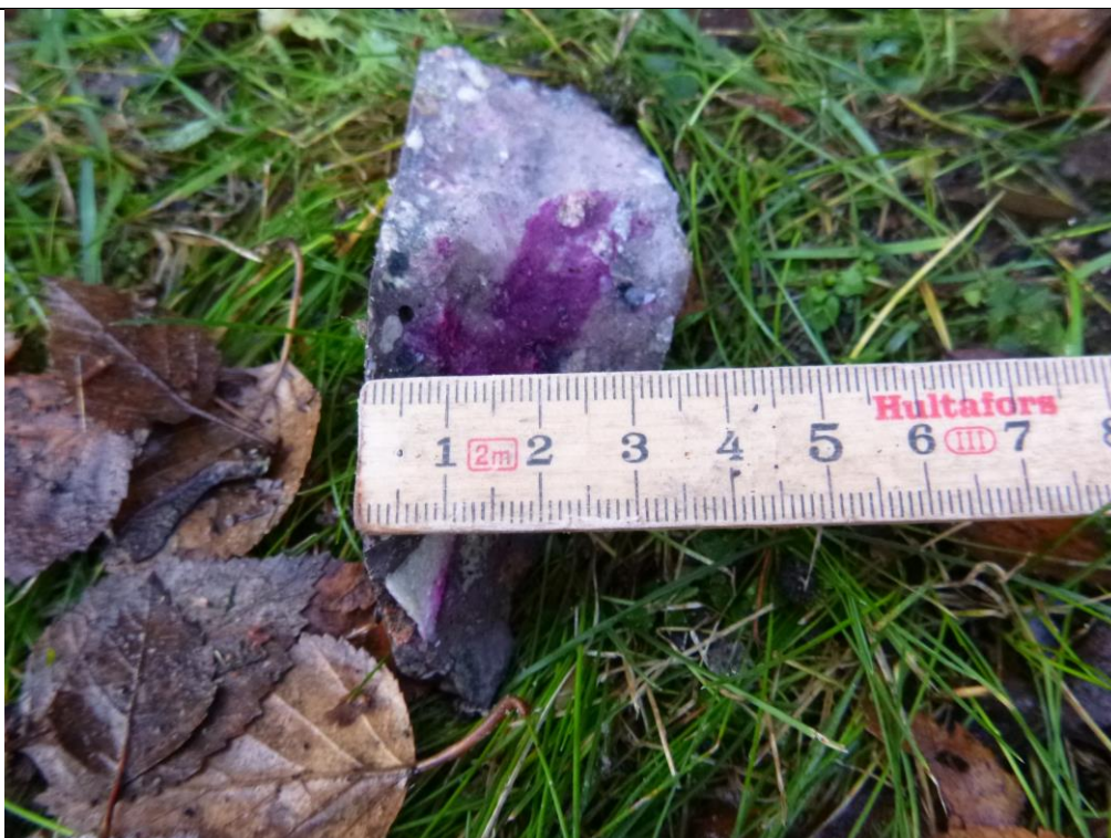
Foto 13: (P1090564.JPG) Karbonatisering 8 mm fra bagside og 14 mm fra forside.
